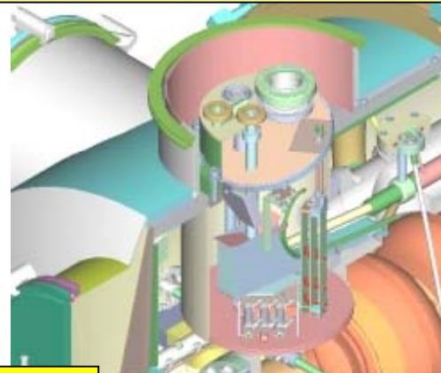
Cryostat pot heater
