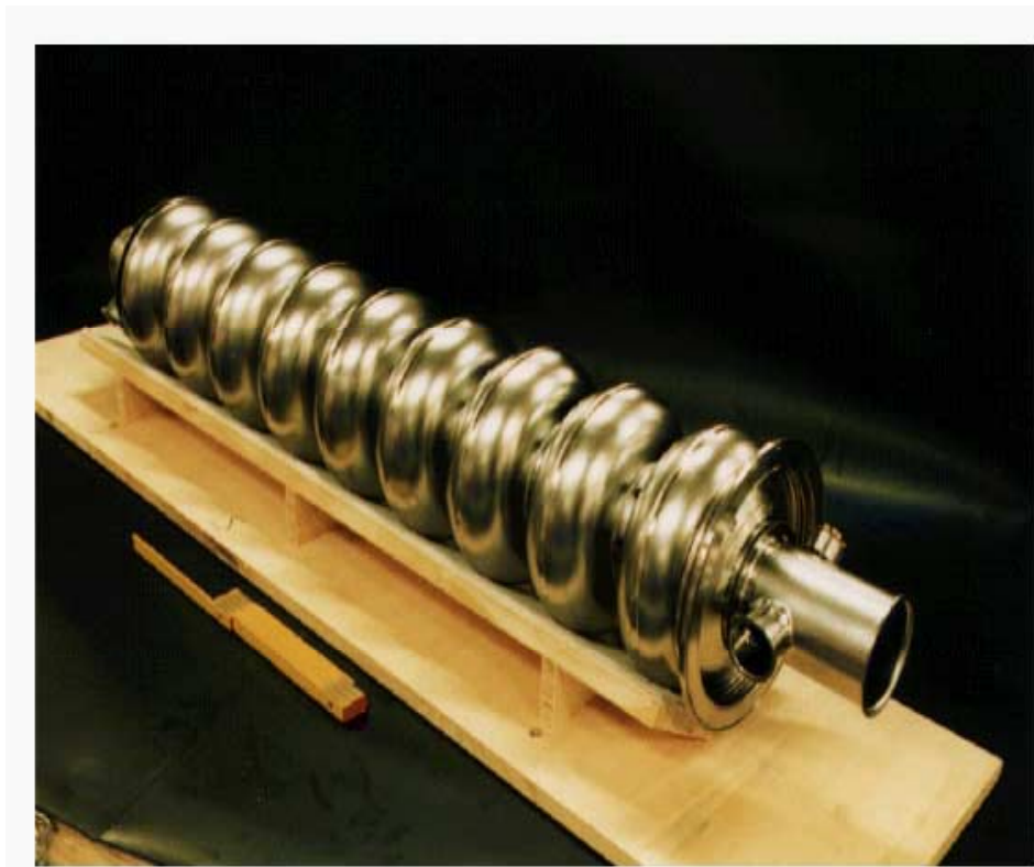
Fig. 5.2.3.1-2. TTF 9-cell 1300 MHz cavity (TESLA 2001)
