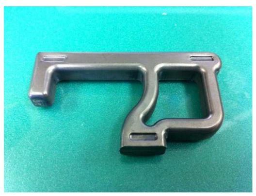
HF rinse (30min) + BCP (200 $\mu$ m) + HF rinse (30min)
